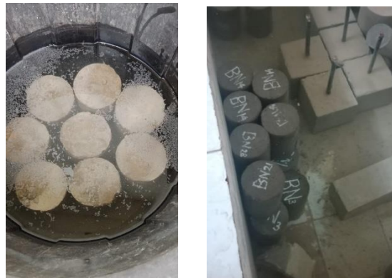
Gambar 2. Curing beton Scc Air kelapa dan beton normal
